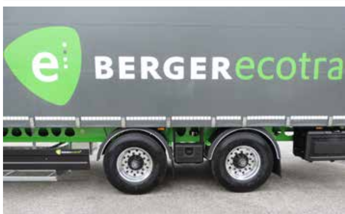
Rozstaw osi naczepy to 1820 mm. Ogumienie to standardowe naczepowe opony o rozmiarze 385/65 R22,5.
