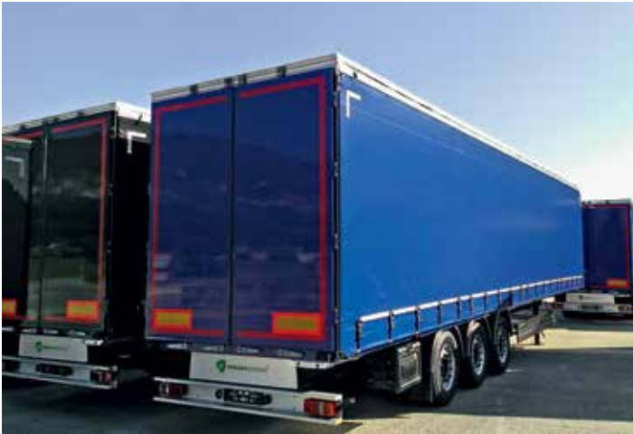
Obecnie produkowane naczepy BERGERecotrail® mają bardziej aerodynamiczną osłonę nad zderzakiem
