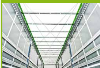
Sterowane układem 4 linek lekkie, zsuwane i podnoszone dachy dostarcza Edscha.
