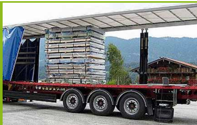
Podczas wizyty w fabryce polscy przewoźnicy obejrzeli test – ładunek o masie 29 ton został ułożony punktowo tuż przed pierwszą osią naczepy.
