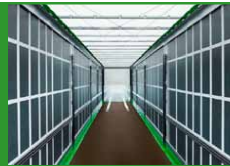
Wnętrze nowej naczepy mega ma wysokość 3000 mm. Podnoszony i zsuwany dach typu Ultraline z czterolinkowym mechanizmem roboczym dostarcza firma Edscha.
