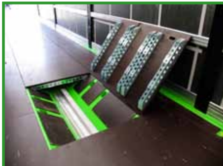
Mulda ma długość 8222 mm i służy do bezpiecznego transportu kręgów stali o średnicy od 900 do 2000 mm. Jest zamykana pokryciami tworzącymi jednolitą powierzchnię z podłogą.
