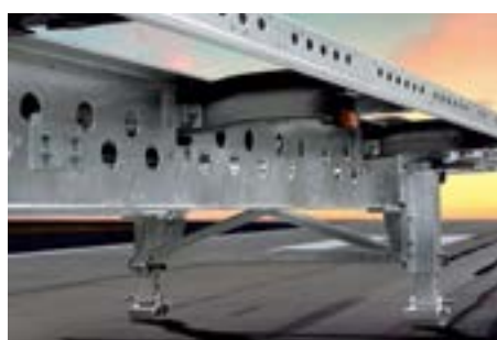
Schmitz Cargobull łączy w swoich naczepach m.in. stal z aluminium by obniżyć ich masę
