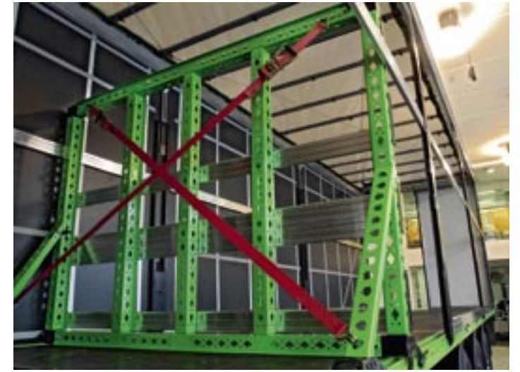
Berger Fahrzeugtechnik oferuje także zabezpieczenie ładunku, jak np. widoczna na zdjęciu ścianka stosowana np. do transportu napojów
