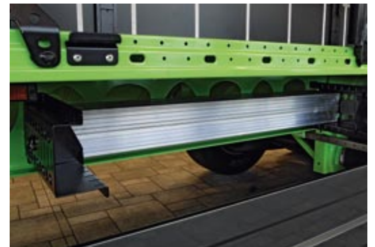
Nie używane elementy zabezpieczające zwoj stali można przewozić w skrzynce w podwoziu
