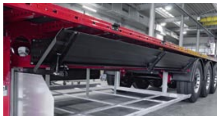
Na życzenie klienta w podwoziu montowany jest lekki kosz na euro-palety
