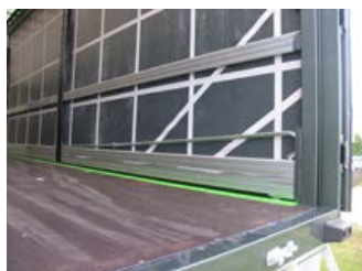
Podłoga ecotrail-hybridfloor wykonana jest z laminowanego drewna...
