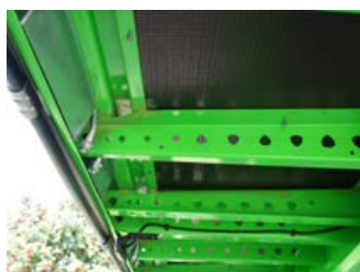
... i wzmocniona od spodu tkaniną ze sztucznego włókna, która jednocześnie stanowi ochronę przed wilgocią.
