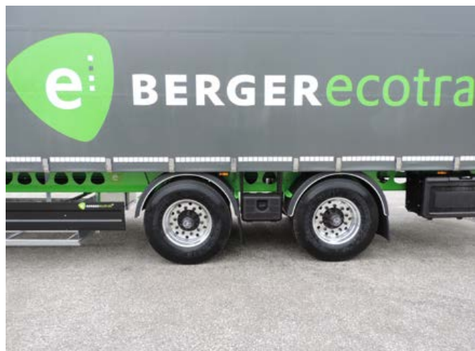
Rozstaw osi naczepy to 1820 mm. Ogumienie to standardowe naczepowe opony o rozmiarze 385/65 R22,5. Osie mają nośność po 10 ton.
