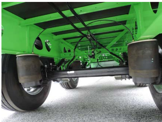
Lekkość naczepy Bergera zawdzięcza jej przemysłowej konstrukcji, chociaż ich podwozie jest całkowicie stalowe. Pneumatycznie zawieszono osie to produkty BPW lub SAF-a.
