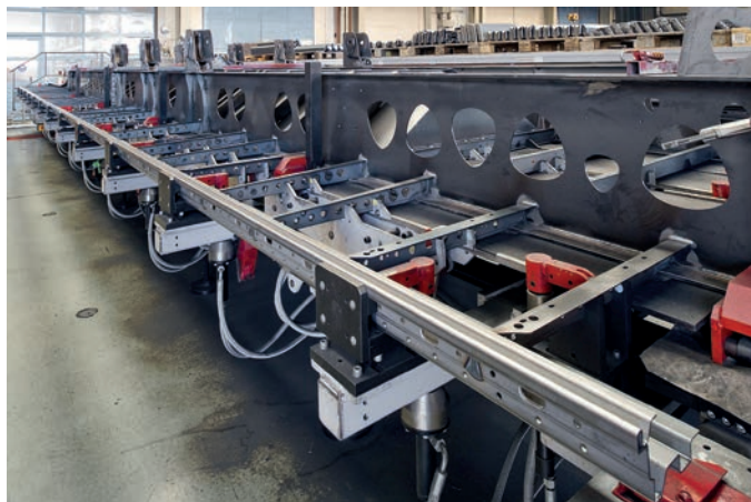
Lekkie, ale wytrzymałe ramy naczep BERGERecotrail® można rozpoznać po charakterystycznych otworach zmniejszających masę o kształcie trójkąta Reuleau. Każda jest spawana w hydraulicznie ustawianych przyrządach i dokładnie mierzona nie tylko przed, ale także po spawaniu. Różnica w długości linii przekątnych nie może być większa niż 2 mm!
