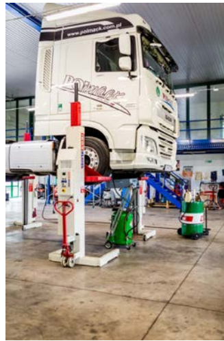
Hydrauliczne podnośniki Stertil Koni umożliwiają podniesienie na wysokość roboczą każdego pojazdu w dowolnym miejscu.
