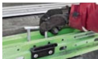
W podłużnicach znajduje się siedemnaście par, chowanych w profilu, uchwyty do mocowania pasów
