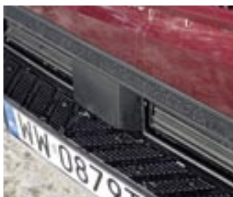
Zamontowany na dole z przodu doplerowski radar mierzy odległość od poprzedzających pojazdów
