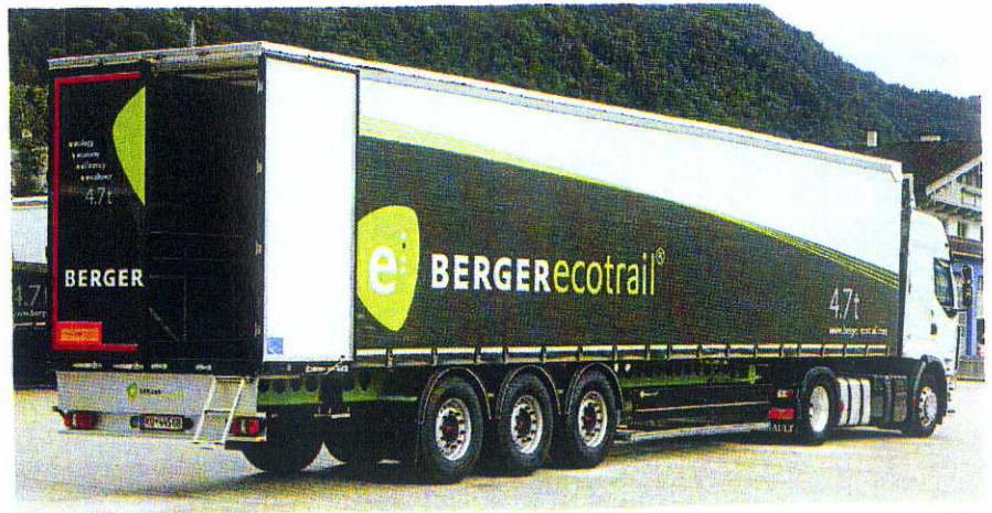
Das Markenzeichen des neuen Bergerecotrail ist das Reuleux-Dreieck. Es verkörpert die statisch perfekte Kontur für höchstmögliche Leichtigkeit und Stabilität
